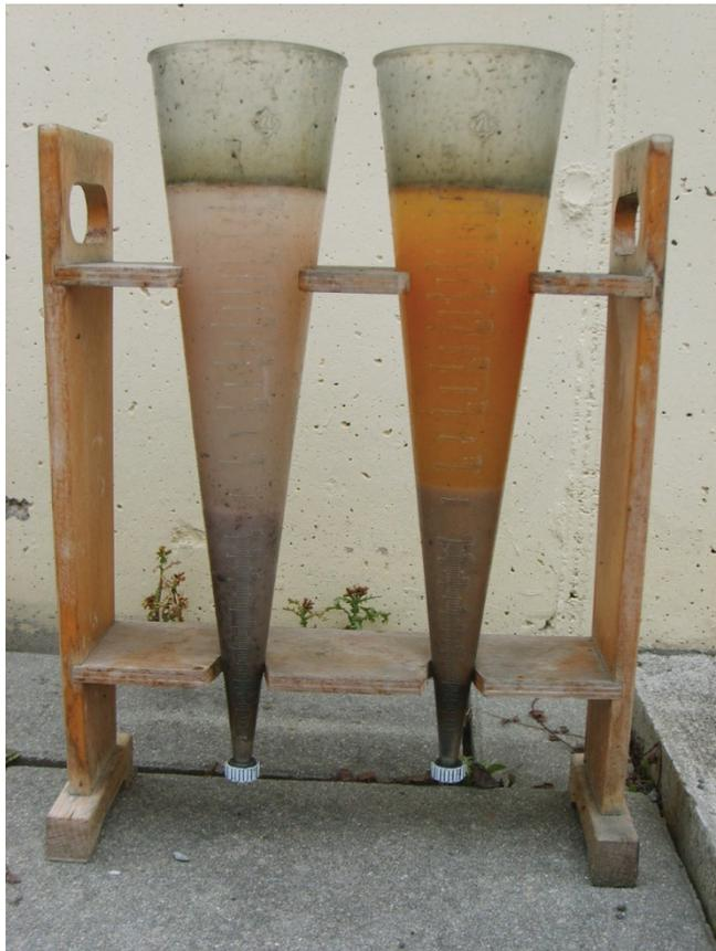
Abbildung 36: Abwasser Sedimentation mit und ohne  $\text{FeCl}_3$
