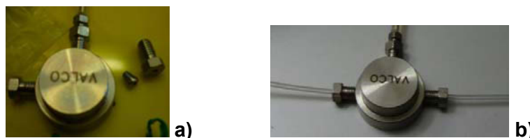
Abb. 4.8: a) Abbildung der Messzelle sowie der Konuse und Mutter. b) Darstellung der Messzelle bei Einbringung des Rilsanschlauches direkt.
