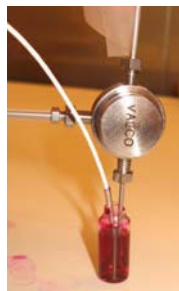
Abb. 4.22: Darstellung der QC-Vermessung der Ampullen durch Eintauchen der Messzelle und des PT 1000 Elementes.
