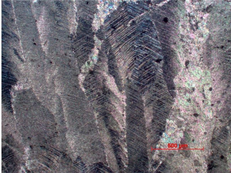
Abbildung 48: Dunkle Dolomitminerale mit Lamellen im Schliff Z13 (mit Analysator)
