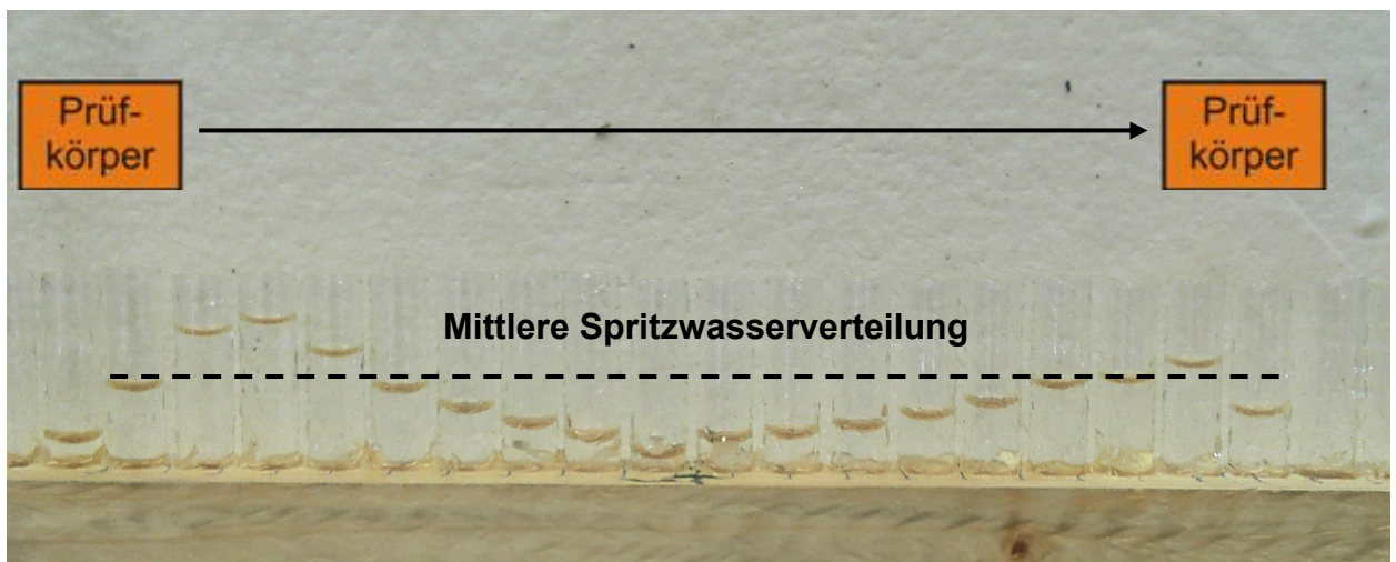
Abbildung 8.7: Spritzwasserverteilung einer Vollkegeldüse
