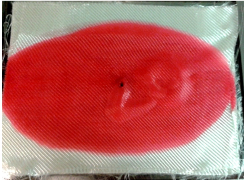
Abbildung 1: Getränkte GF-Gewebe-Probe, Öl gefärbt mit SUDANRED IV
