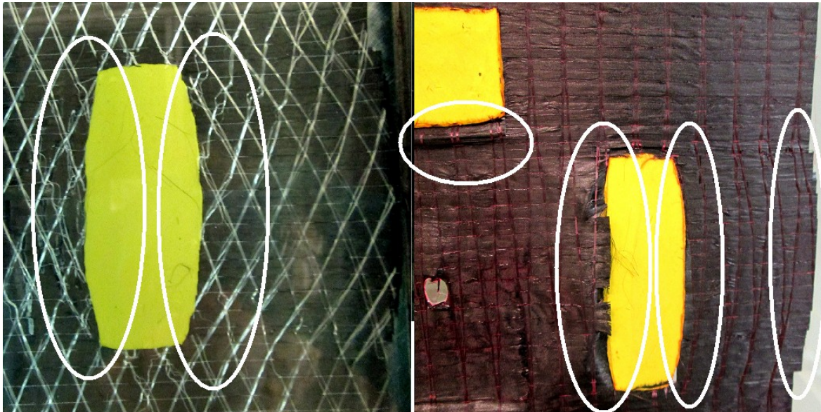
Abbildung 40: Schädigungen durch Barriere in UD-Preform
