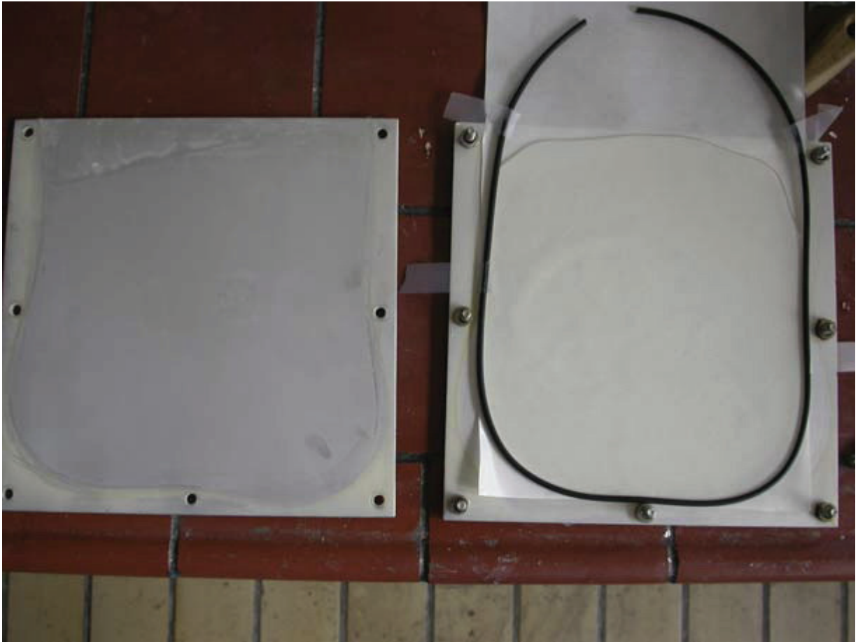
Abb. 3.1: Offene Aluminiumform mit Distanzschrauben und gehärteter Harzplatte.
