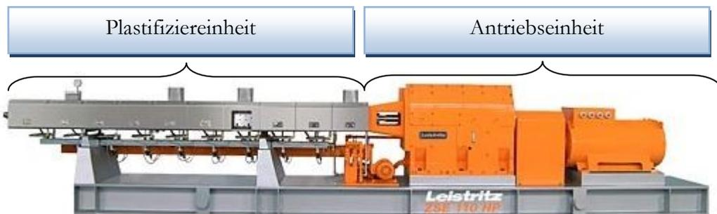
Abbildung 17: Extrusionsanlage der Fa. Leistritz GmbH<sup>49</sup>
