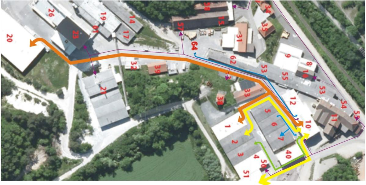
Abbildung 38: Graphische Aufbereitung der Staplerfahrten mit Hilfe des Sankey-Diagramms (Legende ist im Anhang)<sup>76</sup>
