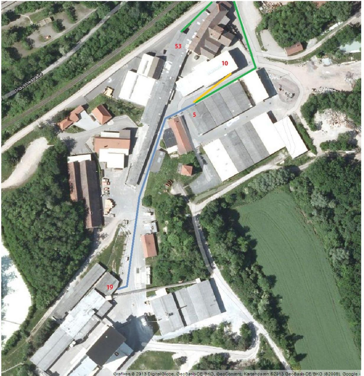
Abbildung 39: Wege für Zu- und Abtransport zum Contra-Mischer; blau gibt den Weg vom jetzigen Standort zum ursprünglichen wieder, orange markiert den Weg von der DOS-Anlage zum Mischer und grün zeigt den Weg vom Mischer zum Lagerplatz<sup>77</sup>
