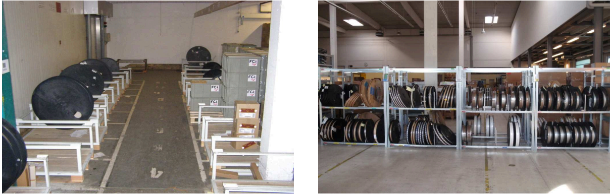
Abbildung 32: Erhöhung der Lagerdichte durch Einführung eines Spulenregales (links: LDL, rechts: FCI Mattighofen)
