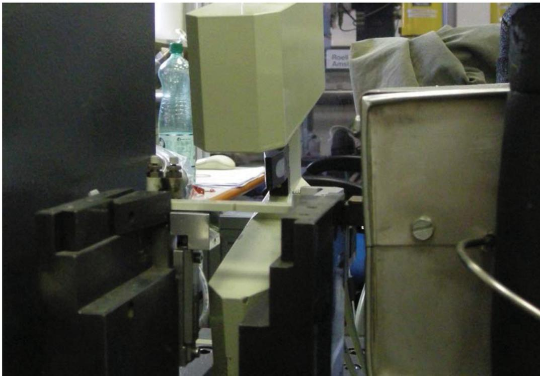
**Abb. 3.3:** Instrumentiertes Charpy-Pendel (Schlagbiegeprüfung): Auflager mit Probekörper, Temperierkammer (in Blechverkleidung) und Pendelhammer
