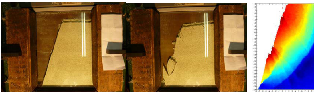
Abb. 3-5: Zwei Aufnahmen derselben Versuchsserie, inkl. Auswertung mit PIV
