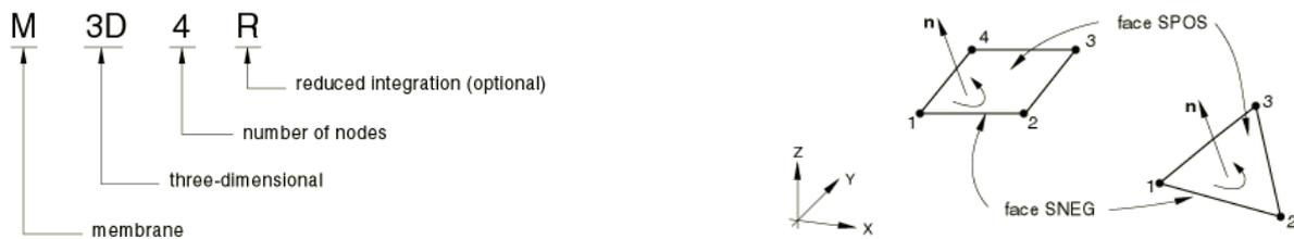
**Abbildung 2.5:** Namens- und Flächenkonvention von Membranelementen [9]
