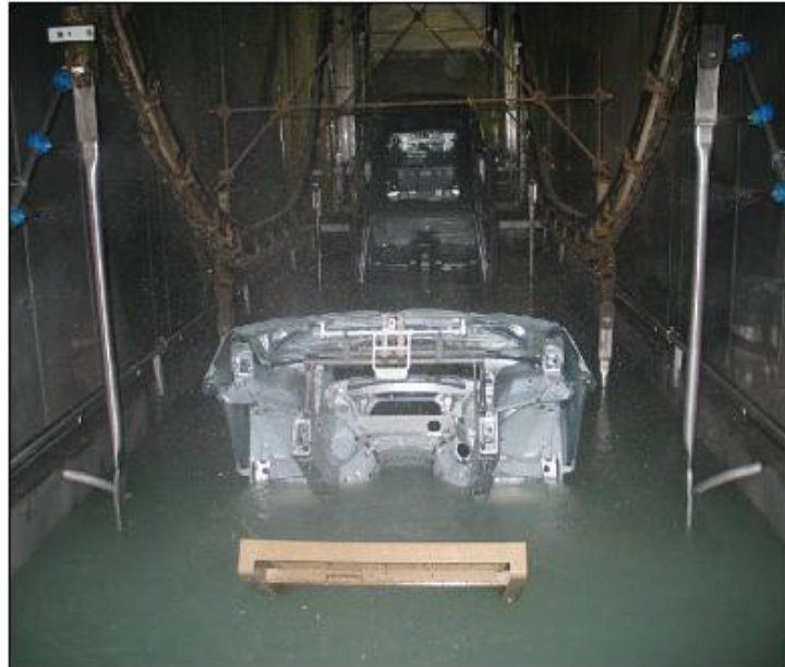
Abbildung 20: VBH Tauchbecken H83 [1]
