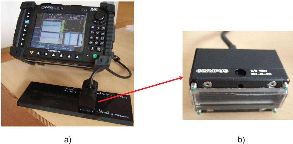
**Abb. 3.3:** a) Verwendetes Ultraschallprüfgerät und b) PA-Ultraschallprüfkopf mit 164 Elementen.
