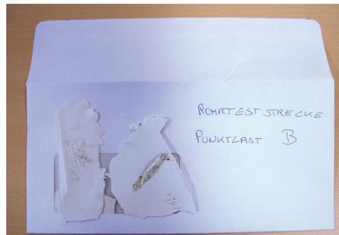
**Abb. 4.6:** Defekt-Negative des Rohrs RTS\_B und deren Archivierung.
