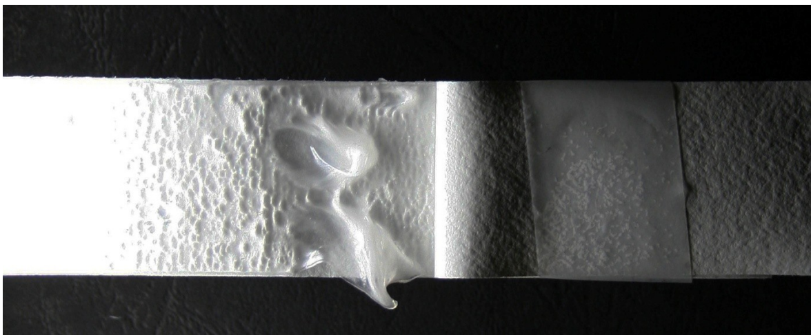
Abb. 4.2: Prüfkörper mit AAA-Rückseitenfolie und plastisch verformtem dow als Einbettungsmaterial nach Adhäsionsbruch im T Peel Test bei 23°C.
