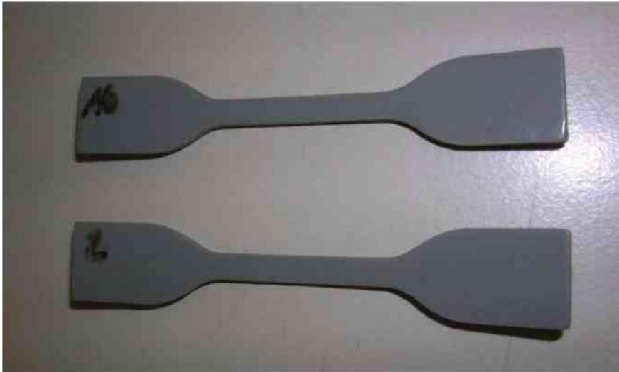
**Abb. 3.2:** Gestanzte Typ 5a-Zugprüfkörper gemäß ISO 527.
