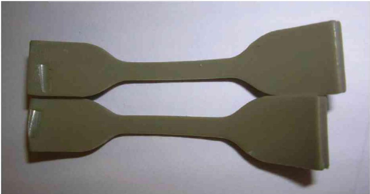
**Abb. 4.3:** Verfärbung der Prüfkörper (Compound P06 nach 6-monatiger Lagerung in Luft bei 135°C).
