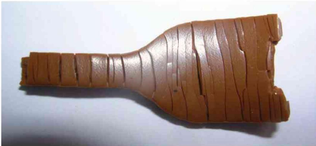
**Abb. 4.4:** Zerbrochener Prüfkörper (Compound P00 nach 6-monatiger Lagerung in Luft bei 135°C).
