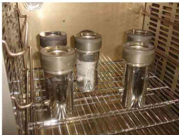
**Abb. 3.8:** Wasserauslagerung im Wärmeschrank.
