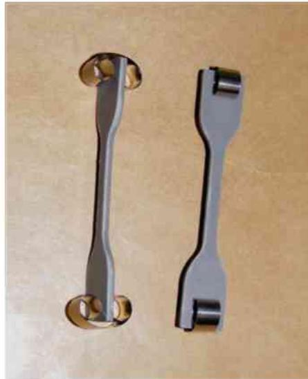
**Abb. 3.7:** Prüfkörper vor Auslagerung mit Klammern.
