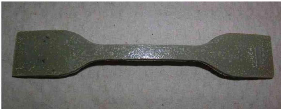
**Abb. 4.27:** In Wasser ausgelagerter Prüfkörper P03 nach 6 Monaten bei 135°C.
