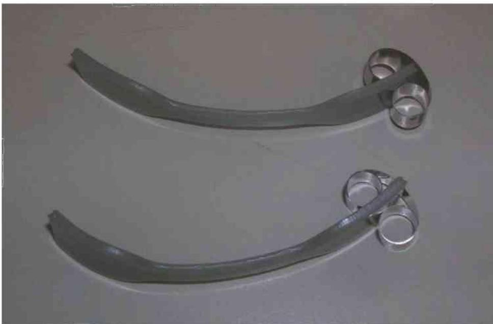
**Abb. 4.2:** Verformte Prüfkörper (Compound P08 nach 6 Monaten in Luft bei 125°C).
