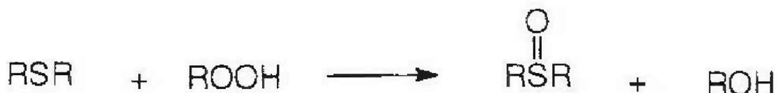
**Abb. 2.4:** Reaktionsmechanismus der sekundären Antioxidantien am Beispiel eines Thioesters.
