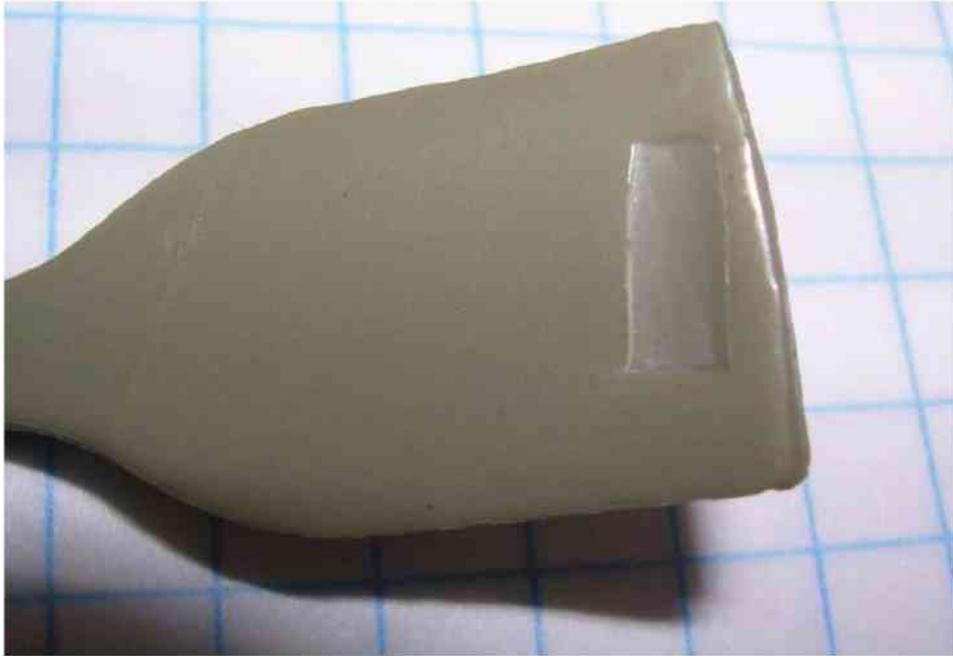
**Abb. 4.1:** Eindruck der Befestigungsklammer.
