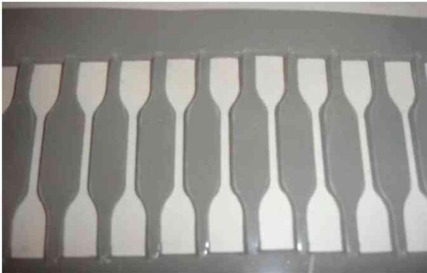
**Abb. 3.3:** Platte mit herausgestanzten Proben.
