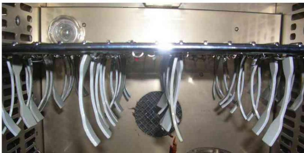
**Abb. 3.4:** Luftauslagerung im Wärmeschrank.
