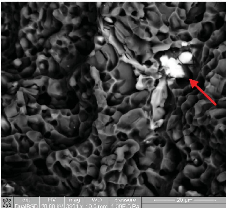
Abbildung A9: Intermetallische Sr-Phase, BSD, Vergrößerung 4000x
