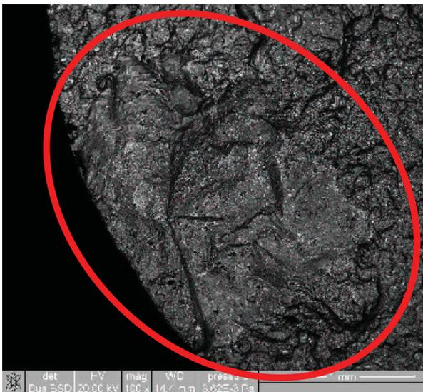
Abbildung 4-8: Probe 3\_18 Einschluss, BSD, Vergr. 100x
