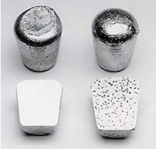
Abbildung 2-7: Unterdruck-Dichte-Proben (links: niedriger Gasgehalt, rechts: hoher Gasgehalt) [28]
