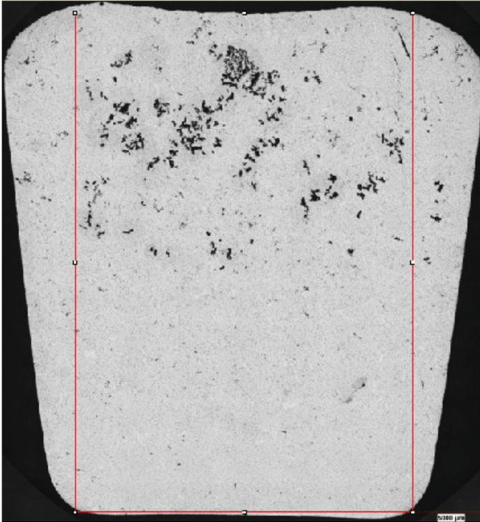
Abbildung 4-3: Bild Probe Nr. 1\_10a mit rot eingezeichnetem Messrahmen
