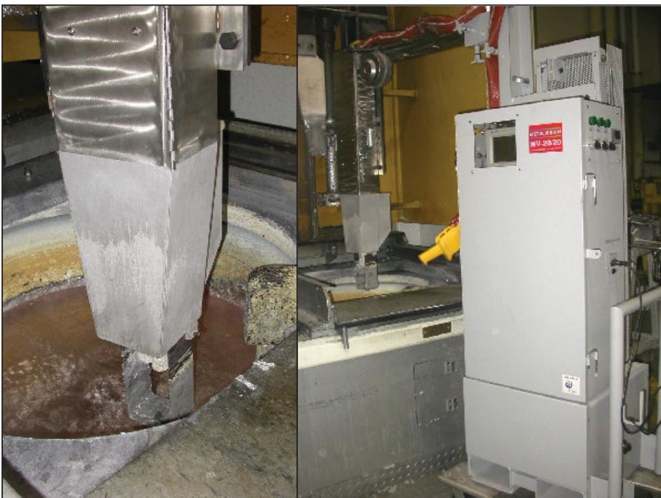
Abbildung 2-10: MetalVision Ultraschall-Prüfsystem
