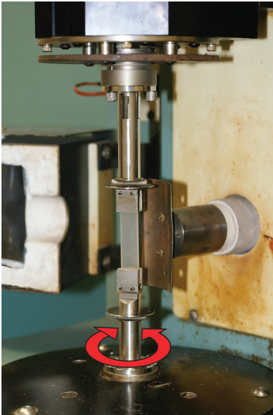
Abb. 3.10: Eingesetzte Torsions-Einspannvorrichtung mit Darstellung der Belastungs- und Einspannverhältnisse (links) sowie schematischer Darstellung der Einzelkomponenten (rechts) (Eyerer et al, 2008).
