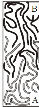
Abbildung 11: Schematische Darstellung der Interdiffusion von Molekülketten [26]
