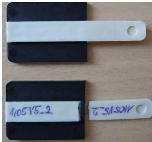
Abbildung 37: Ungeprüfter und geprüfter Schälprüfkörper der Materialpaarung Grilamid LV5H – Kraiburg TC6PNC
