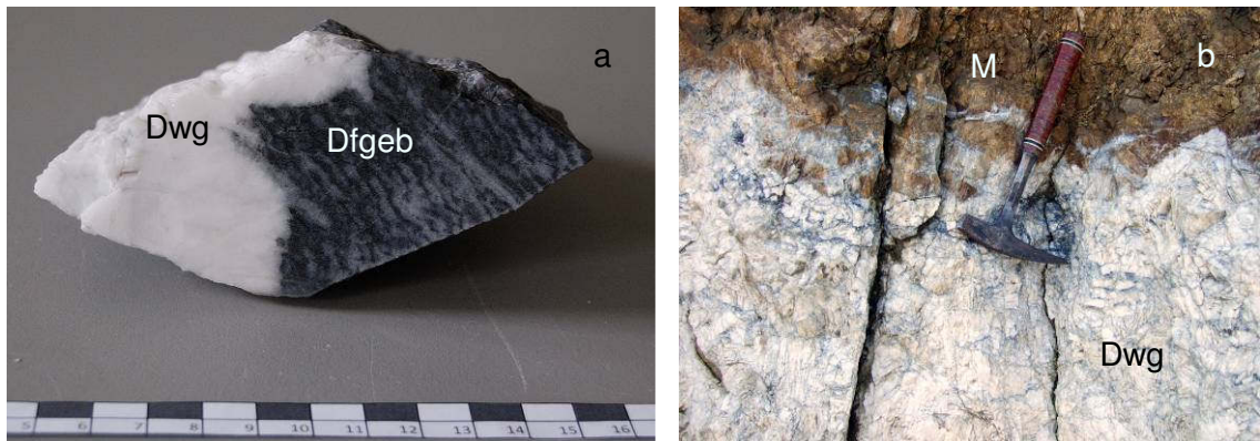
Abbildung 46: a) Kontakt Dwg/ Dfgeb; b) Rosszahndolomit (Dwg) in Magnesit, Tagbau.
