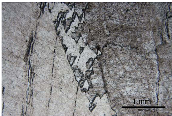
Abbildung 47: Zwei Rosszahndolomitkristalle mit randlicher Verwachsung, Dünnschliff 63-1, IIN.
