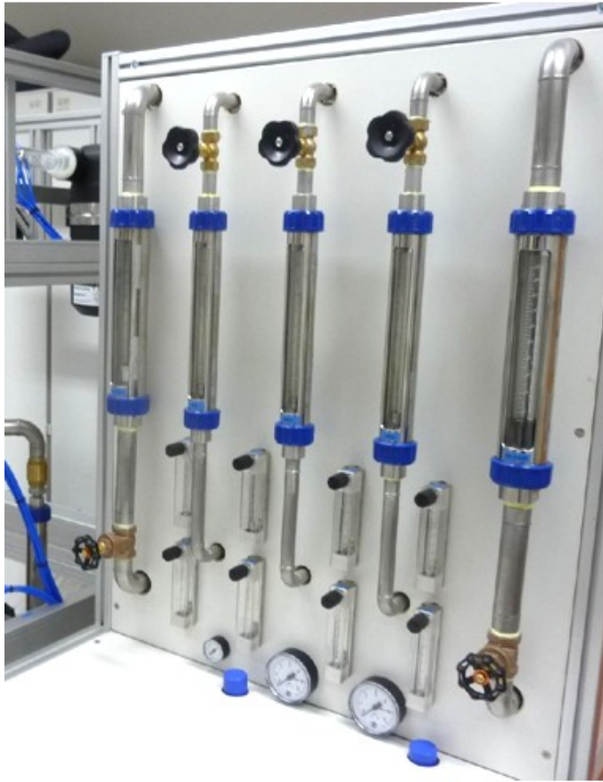
Abbildung 34: Foto der Anordnung der Durchflussmesser der Firma Krohne
