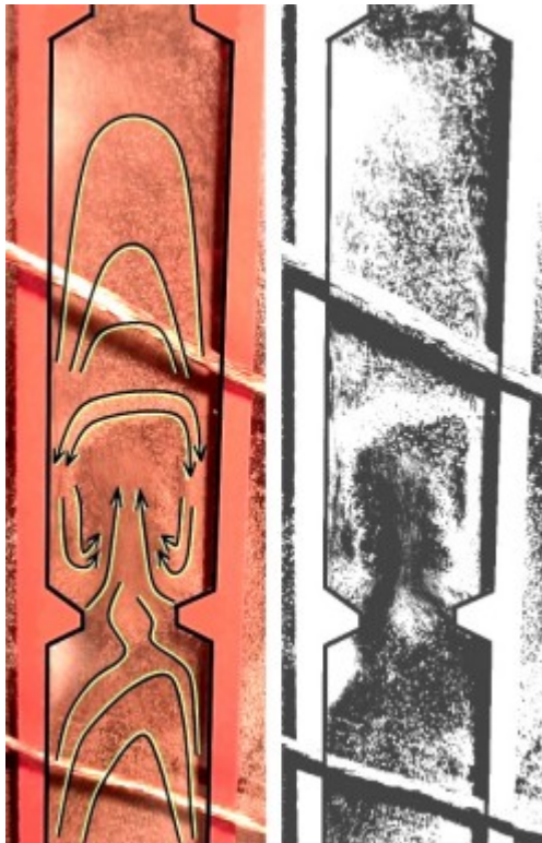
Abbildung 26: Feststoffverteilung innerhalb einer durch die Einschnürung verursachten Zone [76]
