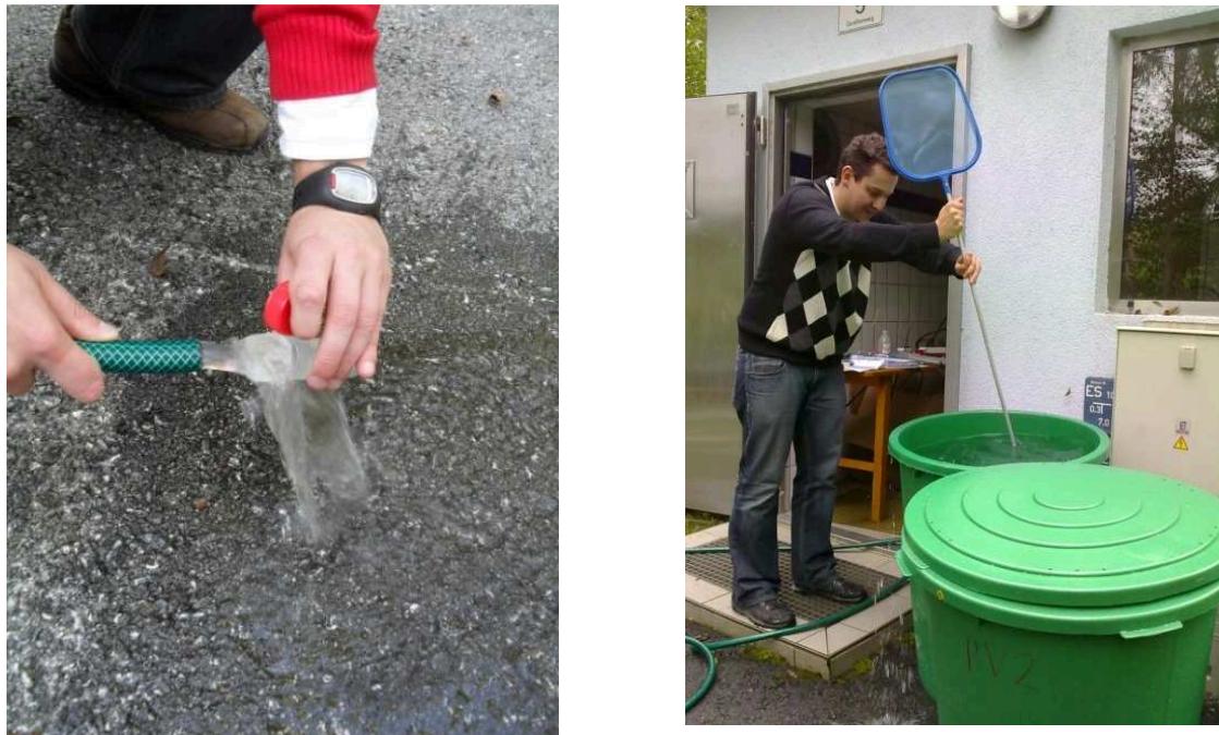
Abbildung 34: Probenahme aus dem Schlauch (links) und aus der Tonne (rechts)
