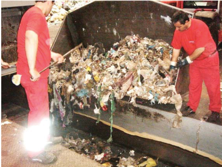
Abbildung 17: manuelle Aufgabe der Hochkalorik auf das Austragsband Sackaufreißer
