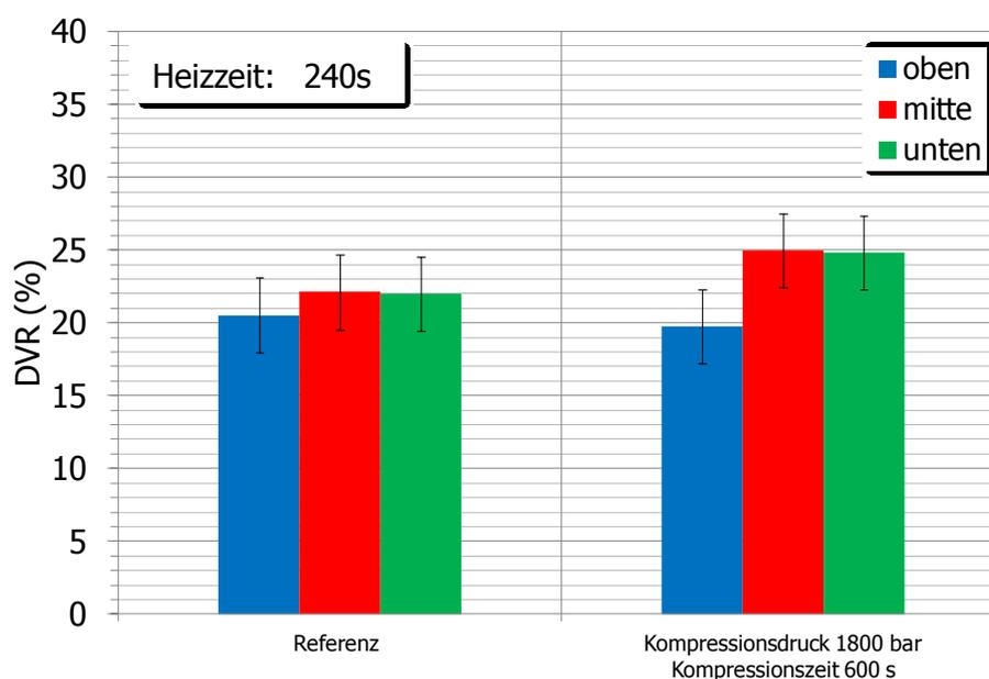
Abbildung 32: Ergebnisse der DVR Messung der SBR-Formteile mit 240 s Heizzeit.
