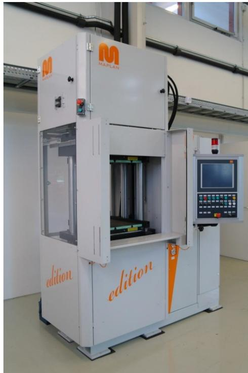
Abbildung 8: Elastomerspritzgießmaschine MTF 750/160 edition der Fa. Maplan GmbH [17]
