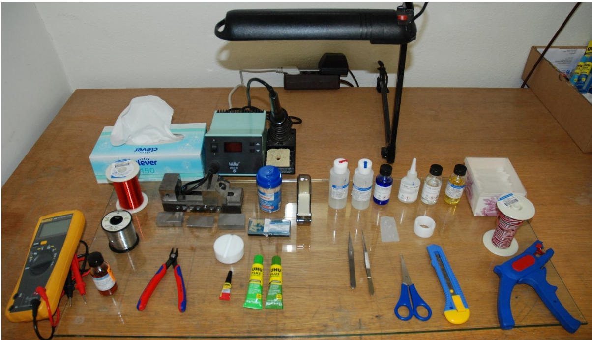
Abbildung 54: Gesamtbild aller verwendeten Utensilien für die DMS-Klebung, den Lötvorgang und der Zugprobenaufhängung.
