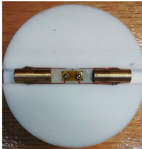
Abbildung 55: Klebeschablone mit eingelegter Y_2O_3 -stabilisierter Zirkonoxid-Probe.
