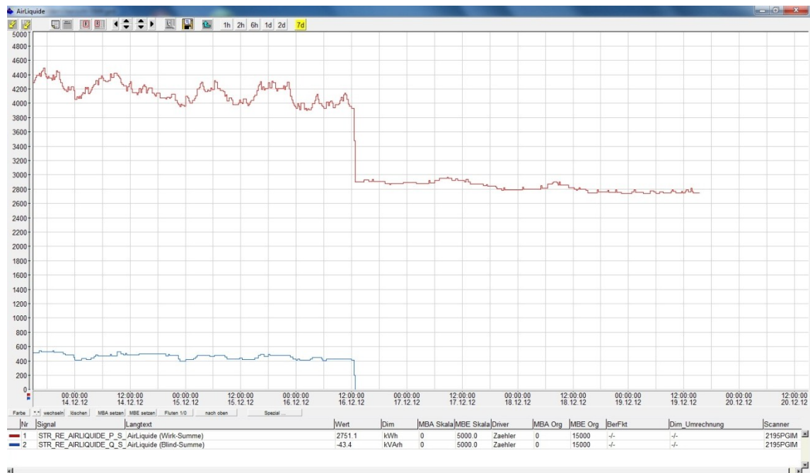
Abbildung 24 - Typisches Lastprofil der Anlagen der Fremdfirma Air Liquide über 7 Tage
