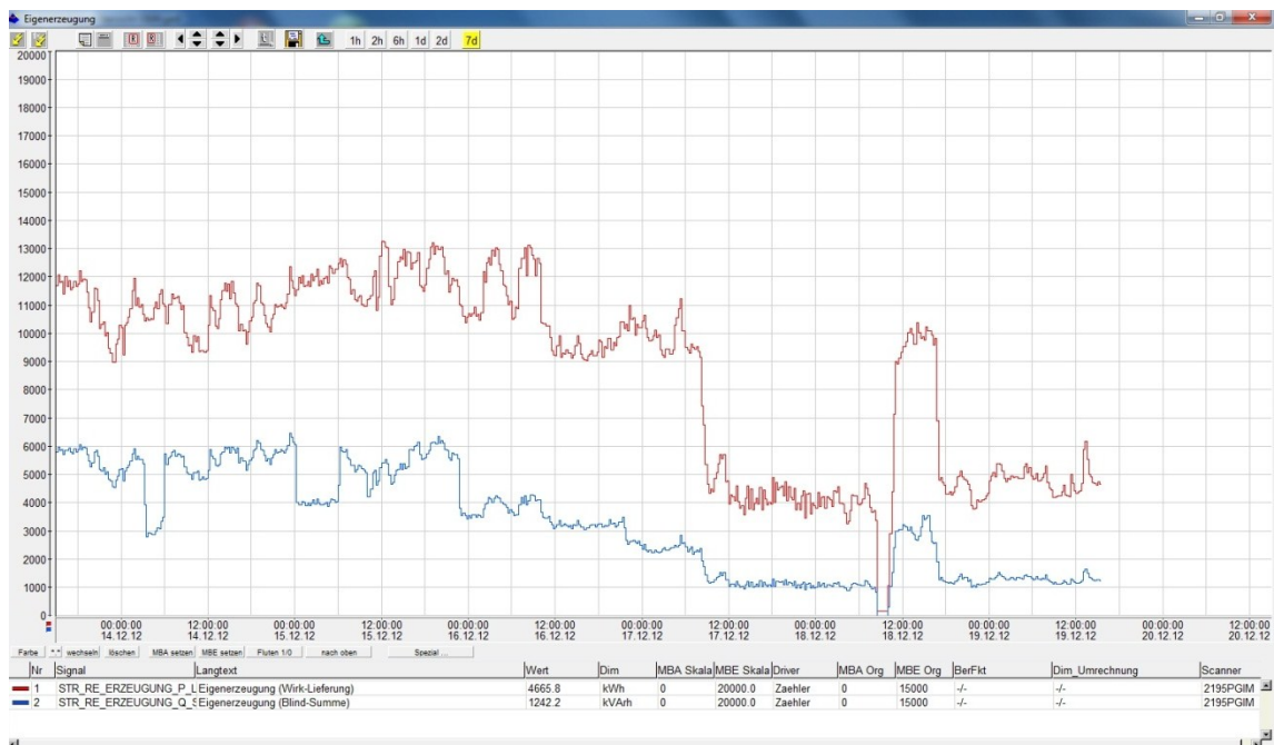
Abbildung 25 - Typisches Lastprofil der Eigenerzeugung durch das Kraftwerk am Standort Donawitz über 7 Tage
