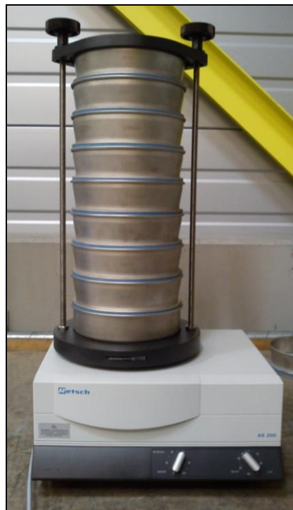
Abbildung 48: Aufbau der RETSCH Analysen-Siebmaschine
