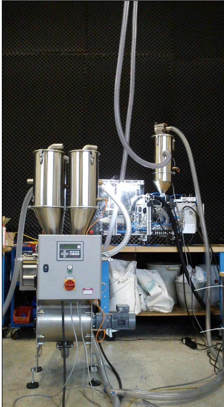
Abbildung 62: Versuchsaufbau 3 Probenahme erfolgt nach einer 5 m nach oben und wieder 5 m nach unten vertikalen Förderstrecke am Trichteraustritt)
