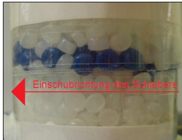
Abbildung 41: Befüllung des Modellzylinders mit zwei farblich unterschiedlichen Granulaten. Das obere Ende des Zylinders ist dabei offen, somit sind die Granulatkörner nach oben frei beweglich.
