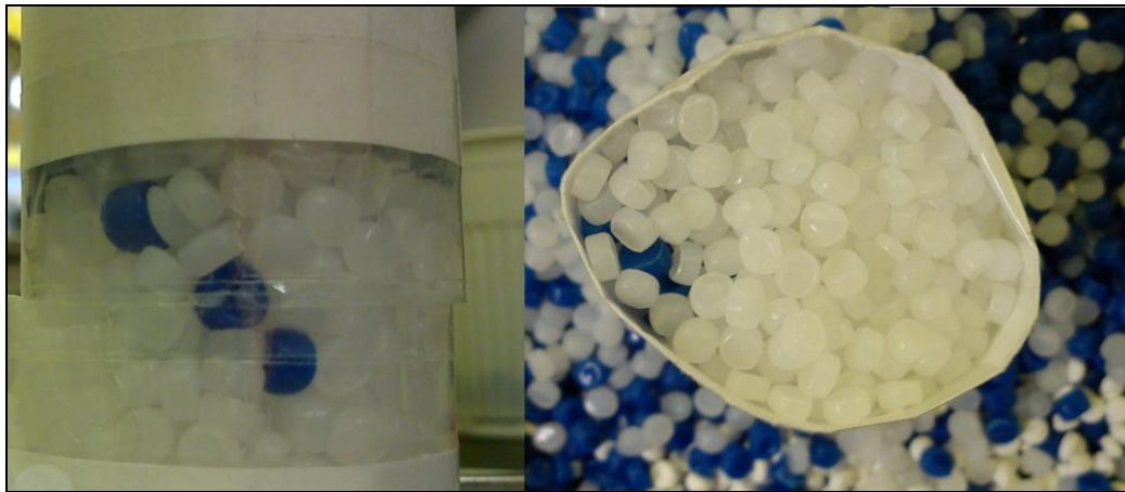
Abbildung 43: links: Rückseite der Trennebene Ansicht von links) nach 22 Einschubvorgängen; rechts: Draufsicht Zylinder ist oben offen )
