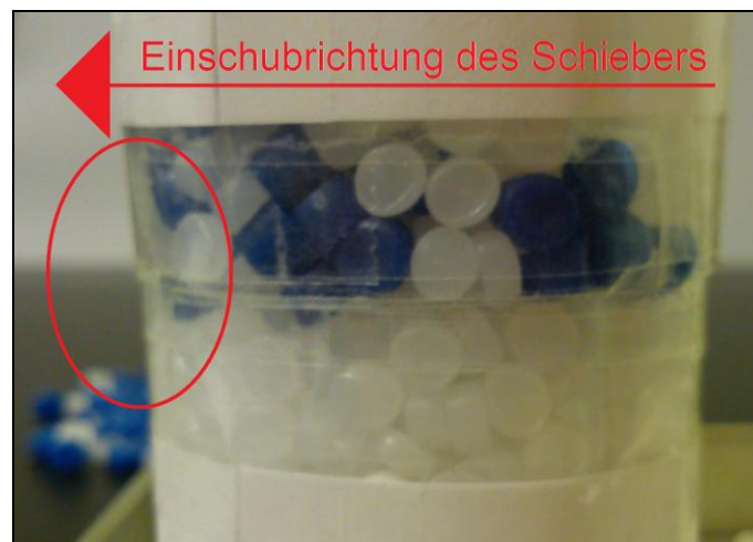
Abbildung 44: Seitenansicht der Trennebene nach 22 Einschubvorgängen Zylinder ist oben verschlossen und wurde mit leichtem Druck beaufschlagt); der rote Kreis deutet die Richtung der Ansicht in Abbildung 45 an
