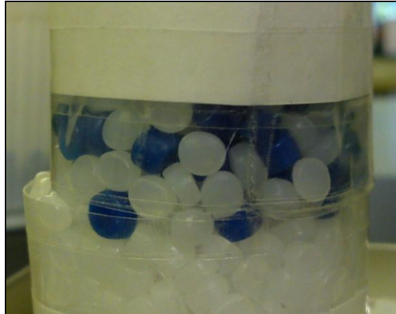
Abbildung 45: Rückseite der Trennebene Ansicht von links) nach 22 Einschubvorgängen Zylinder ist oben verschlossen und wurde mit leichtem Druck beaufschlagt)
