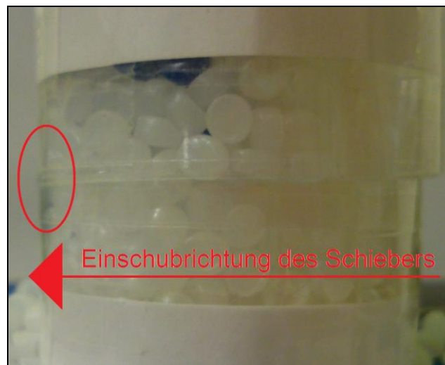
Abbildung 42: Seitenansicht der Trennebene nach 22 Einschubvorgängen (Zylinder ist oben offen); der rote Kreis deutet die Richtung der Ansicht in Abbildung 43 an
