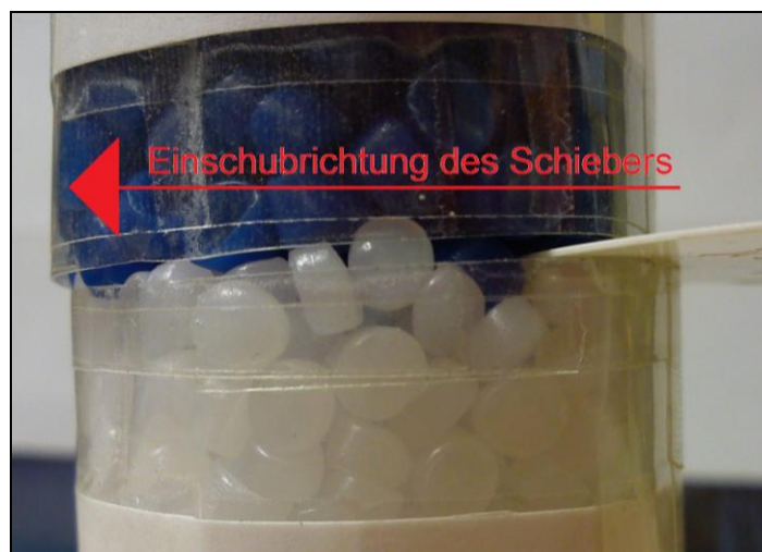
Abbildung 34: Befüllung des Papiermodells und Einschubvorgang des Schiebers
