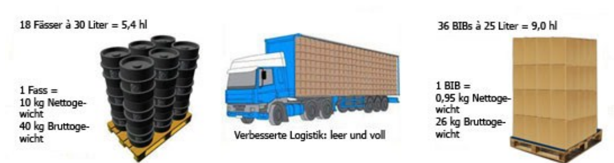
Abbildung 16: Transportvergleich von BIB mit Fässern [16]
