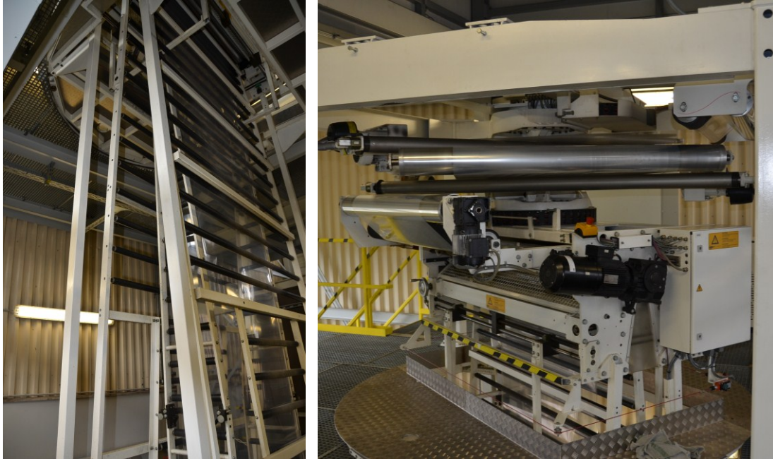
Abbildung 34: Flachlegung und Wendestangensystem
