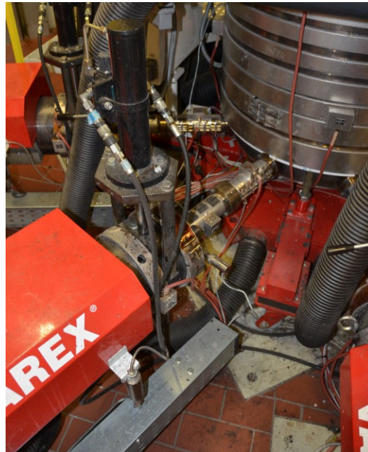
Abbildung 30: Flansch mit Siebhalter
