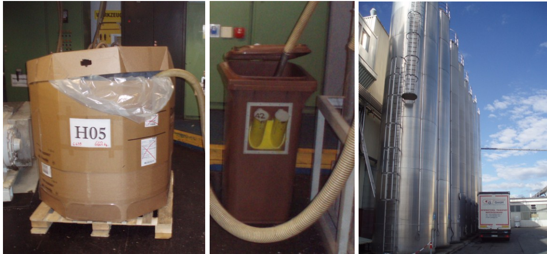
Abbildung 26: Materiallagerungsvarianten Oktapin, Sack (Tonne) und Silo
