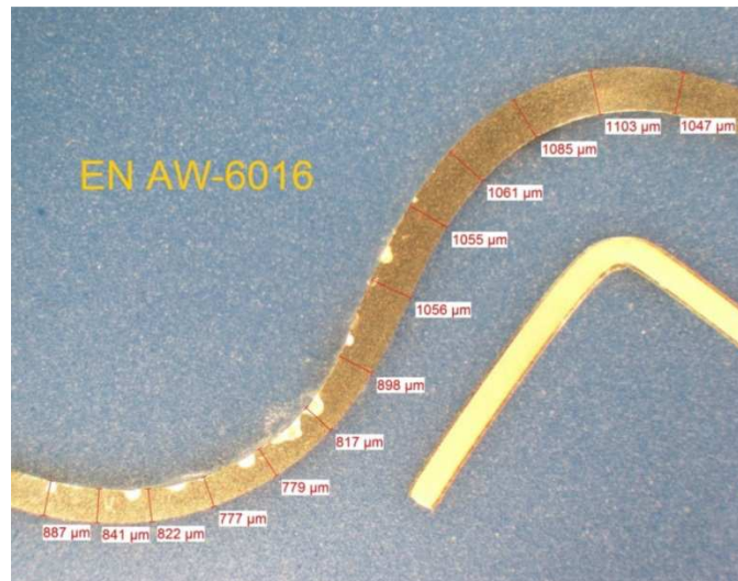
Abbildung 5-12: Blechdickenmessung der Legierung EN AW-6016 mittels eines Stereomikroskopes
