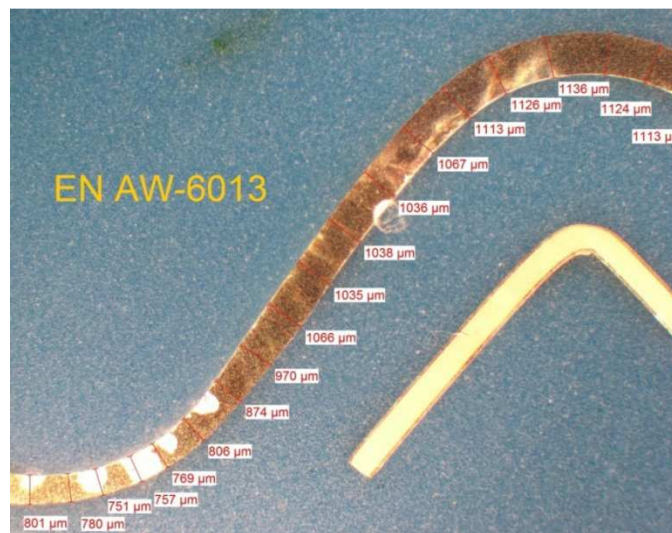
Abbildung 5-13: Blechdickenmessung der Legierung EN AW-6013 mittels eines Stereomikroskopes
