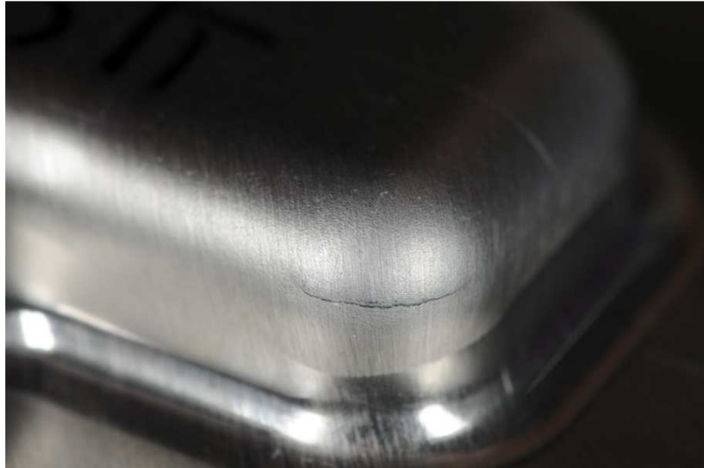
Abbildung 4-29: Eine Probe nach dem Tiefziehversuches mittels einer Kreuzform
