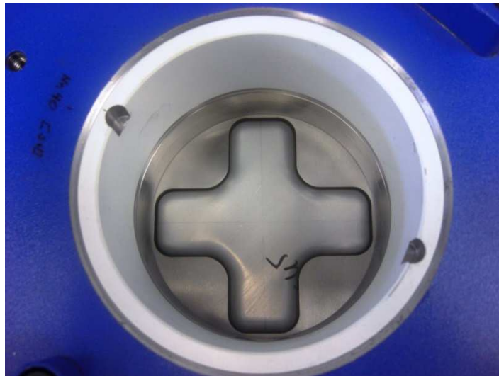
Abbildung 4-19: Probe, die im Moment der Bildaufnahme von unten durch den kreuzförmigen Stempel verformt wird
