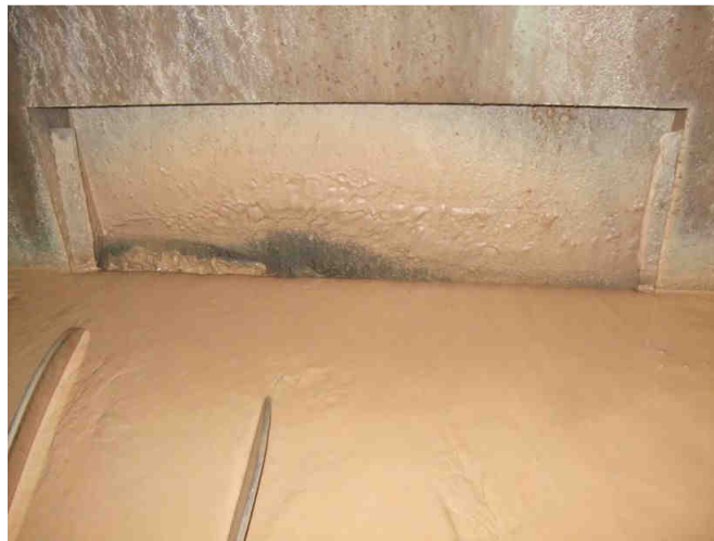
Abbildung 6: Überlauf, Ansicht vom Inneren des Schraubenklassierers
