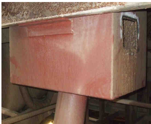
Abbildung 19: Probenahmestelle des Grobguts, Abwurfschurre des Überlaufs
