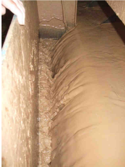
Abbildung 5: Überlauf und Probenahmestelle des Feinguts
