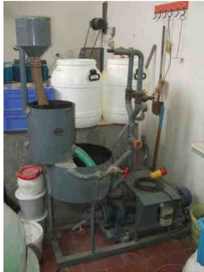
Abbildung 10: Hydrozyklonstand am Lehrstuhl für Aufbereitung und Veredlung, Erstellung des Kennlinienfelds für die eingebaute Pumpe
