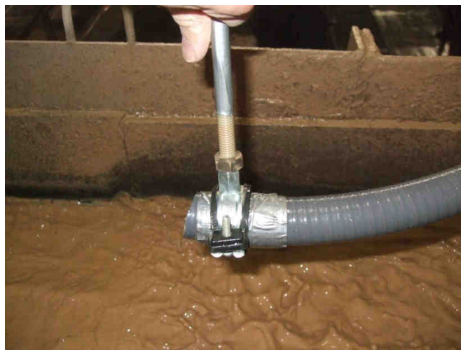
Abbildung 2: Tauchrohr für die Probenahme im Aufgabestrom
