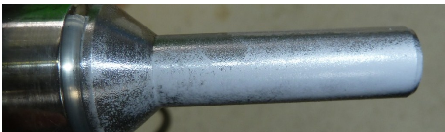
Abbildung 36: Ablagerungen auf der Sauerstoffsonde QI10112
