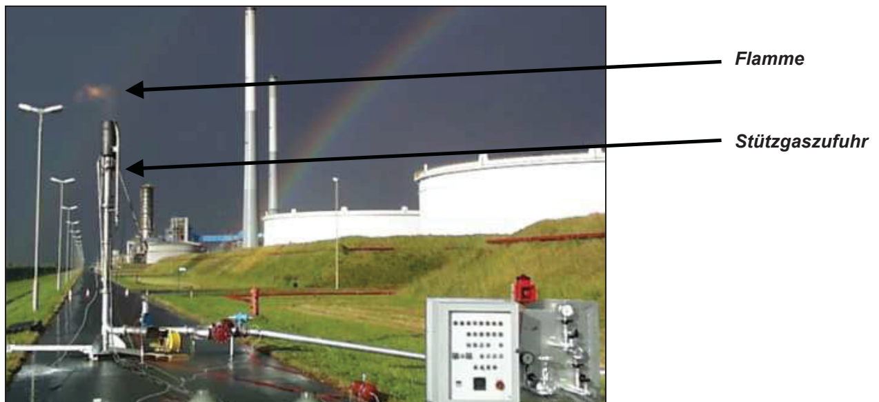
Abbildung 30 Low – NO x - Fackel im Betrieb [35]
