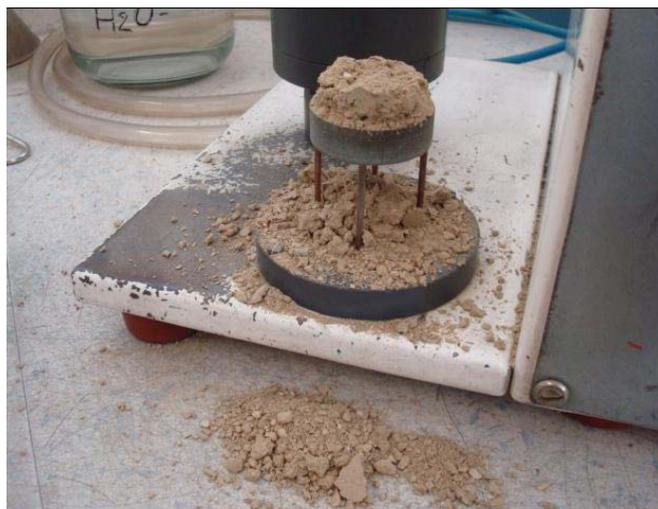
Abbildung 5-19: Prüfvorrichtung mit zerbrochenem Prüfkörper
