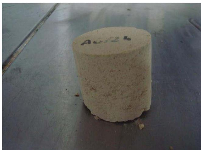
Abbildung 5-17: Prüfkörper der Prüfserie 2 hergestellt mit 10 MPa Pressdruck
