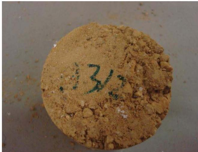
Abbildung 5-22: Stark inhomogener Prüfkörper der Prüfserie 3
