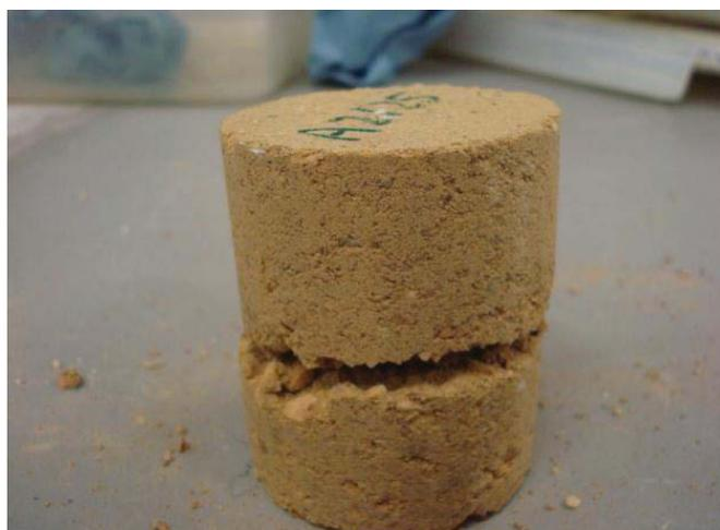
Abbildung 5-24: Zerbrochener Prüfkörper der Prüfserie 4
