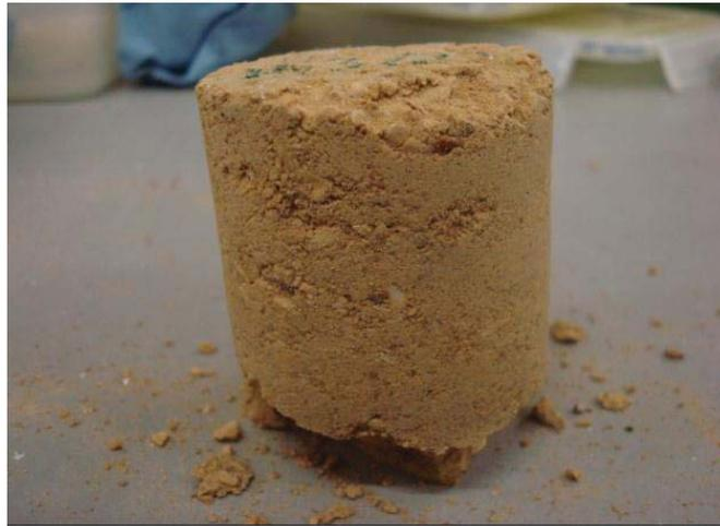
Abbildung 5-21: Prüfkörper der Prüfserie 3 mit starken Ausbrüchen
