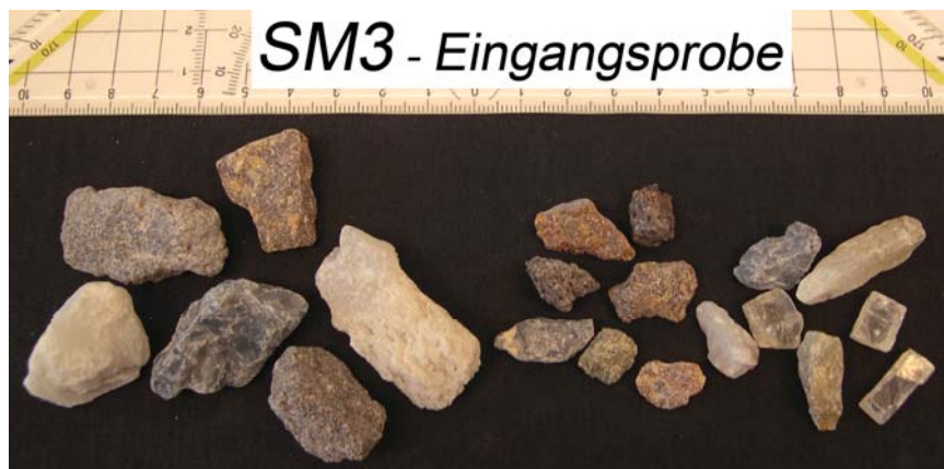
Abb.2.2: SM3; Eingangsprobe nach Siebung: Fraktionen: 40/31,5mm; 16/10mm;
