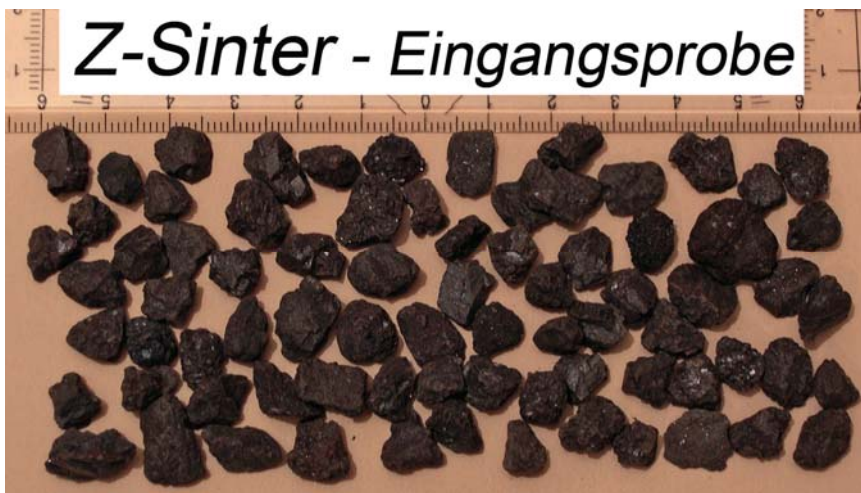
Abb.2.3: Z-Sinter; Eingangssprobe nach Siebung: Fraktion: 10/6,3mm;
