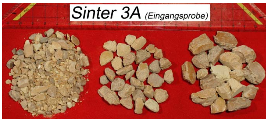
Abb.2.1: Sinter 3A; Eingangspröbe nach Siebung: Fraktionen: 16/10mm; 10/6,3mm; <6,3mm
