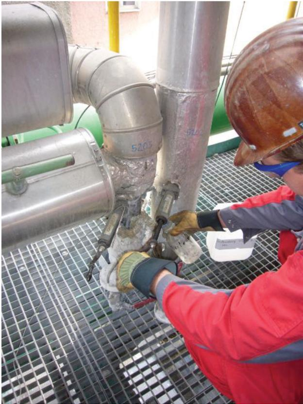
Abbildung 22: Probenahme. Messstelle: Hydrolyserzulauf in der Melamin 5
