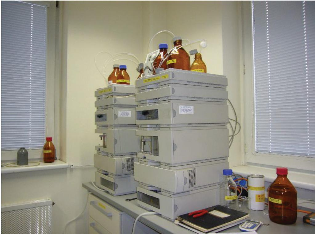
Abbildung 25: HPLC Apparat
