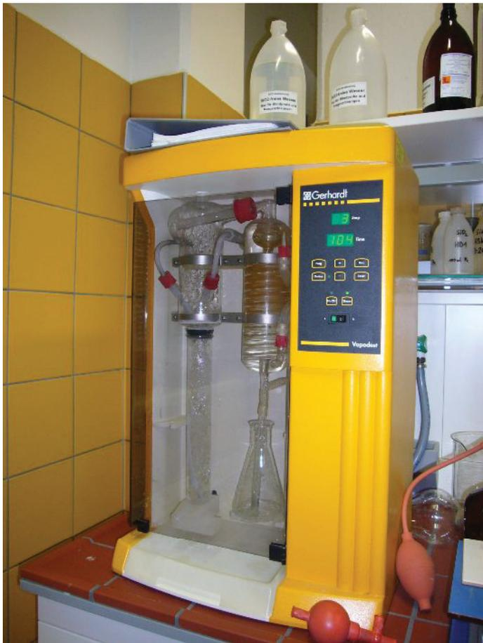
Abbildung 27: Apparat zur Wasserdampfdestillation
