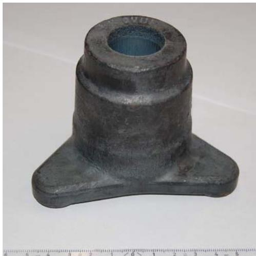
*Abbildung 13: Der in den Schmiedeversuchen hergestellte Abtriebsflansch.*
