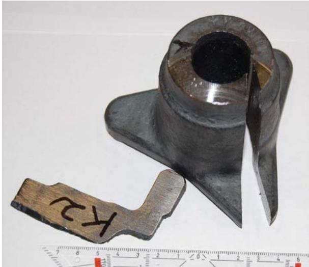
Abbildung 14: Schmiedeteil mit herausgeschnittenem Keil für metallographische Schliffe und Einfräsung im Kopfbereich für die Härteprüfung nach HRC.
