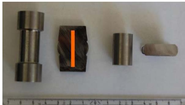
*Abbildung 27: Hantelproben und Zylinderproben für die Stauchversuche. Die Markierung zeigt die Lage der Kerbschlagbiegeproben. Die gezeigten Schnittflächen sind die Flächen an denen die metallographischen Schliffe erstellt wurden.*
