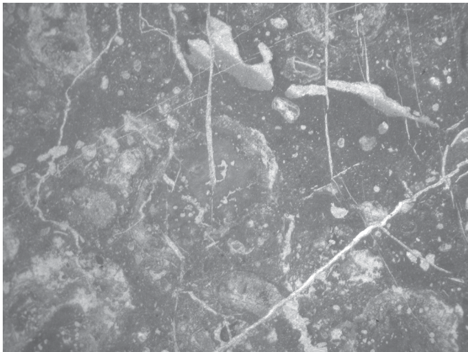
Abb. 104: evaporitischer Wackestone mit umkrusteten Biogenen, Riffbildnern, Schalen, Geopetalgefügen. OK 144, Bildbreite 1,4 cm.
