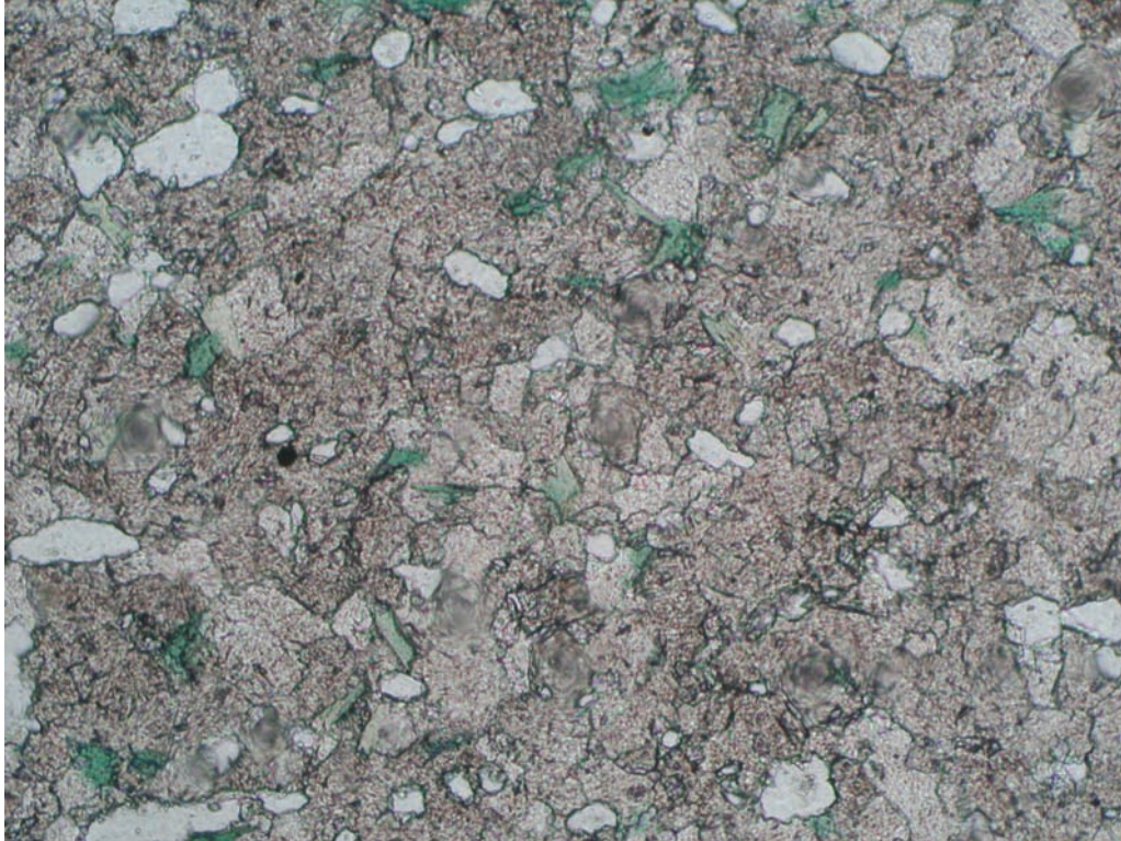
Abb. 40: EB-B9, 100-fache Vergrößerung (Bildlänge 1,4 mm), //N
