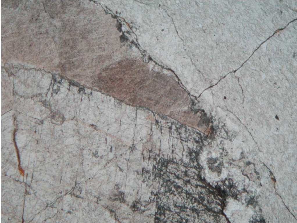
Abb. 22: EB-A6, auf der rechten Seite befindet sich der Porphyr, links ist Siderit zu sehen. 25-fache Vergrößerung (Bildlänge 5,6 mm), //N
