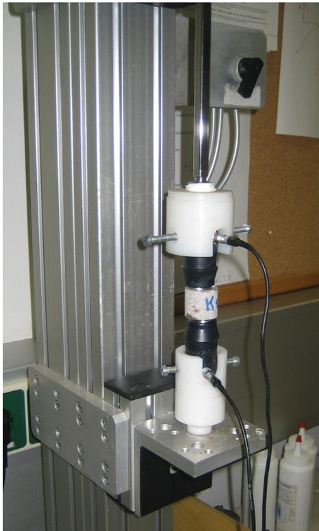
ABBILDUNG 25: PROBE ZWISCHEN DEN PRÜFKÖPFEN BEI DER ULTRASCHALLMESSUNG
