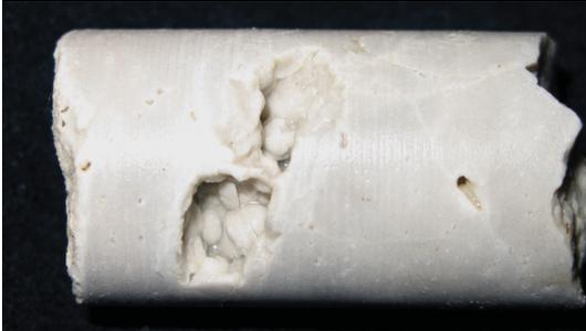
ABBILDUNG 20: DOLOMITKLUFT (LÄNGE DER PROBE CA. 2,2 CM)
