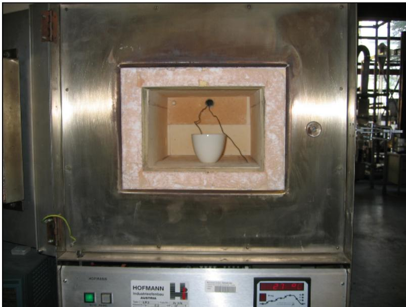
Abbildung 5.1: Elektroofen mit Probe (Hofmann-Ofen)
