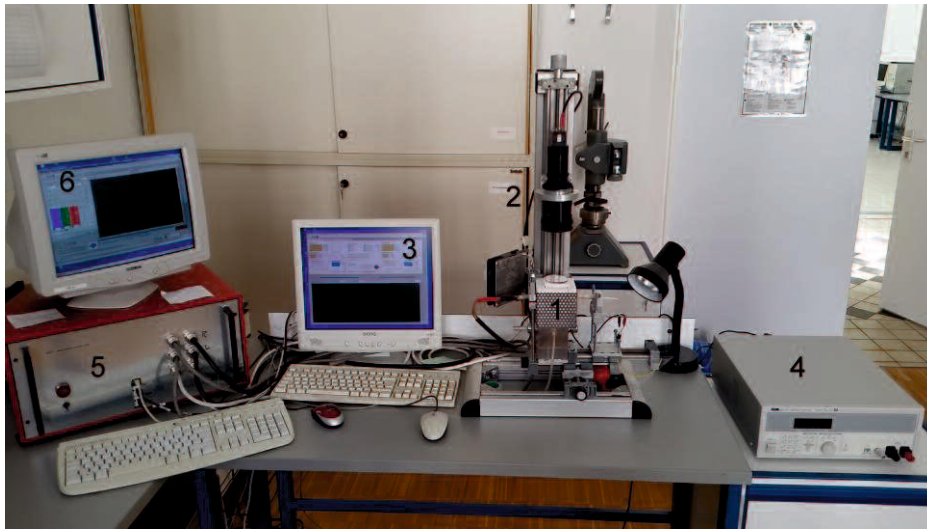
Abbildung 16: Darstellung des Aufbaues der verwendeten Double Hot Thermocouple Technique mit (1) dem Ofenraum mit Heizvorrichtung, (2) dem höhenverstellbaren Stativ mit Kamera und Objektiv zur Aufnahme der Bilder, (3) Steuer- und Regel-PC, (4) Regeleinheit für den Heizvorgang des Ofenraums, (5) Regeleinheit für die Heizdrähte und (6) einem PC für die Bildaufzeichnung und -darstellung
