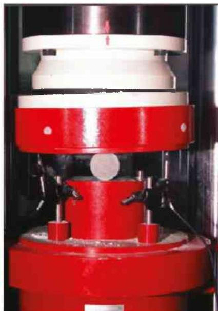
Abb. 4-8: Brazilian-Test Versuchseinrichtung [17]
