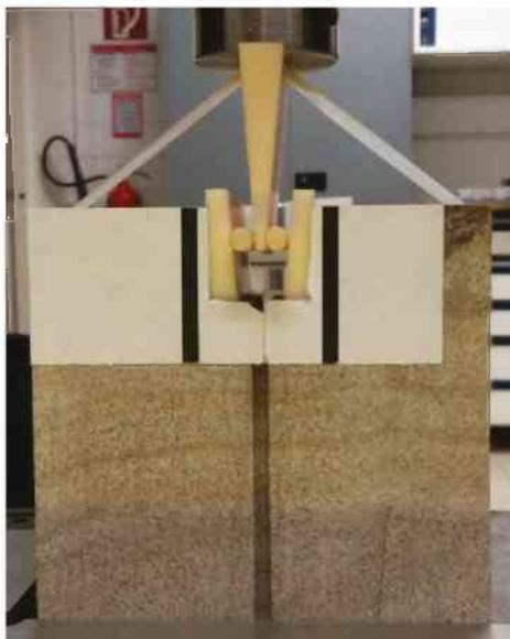
Abb. 3-3: Realer Keilspaltversuch mit einer Sandsteinprobe
