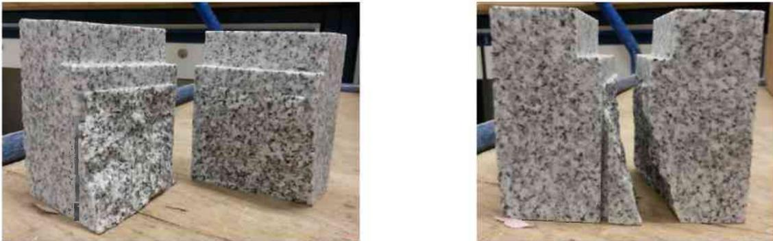
*Abb. 3-6: Granitprobe mit Riss außerhalb der Führungskerbe*
