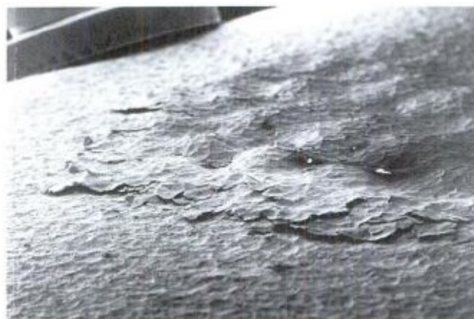
Abbildung 2.14: Platelets auf Reinaluminium 1100 (weichgeglüht), Auftreffgeschwindigkeit 62 m/s unterer 60° [25]
