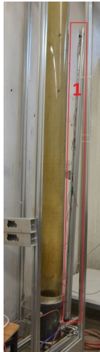
Abbildung 4-1: Fotodioden in Montageleiste
