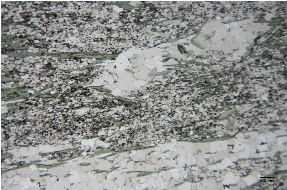
Abbildung 16: Einregelung der Chlorite (Durchlicht, //N), Bildbreite 4 mm, Probe P28
