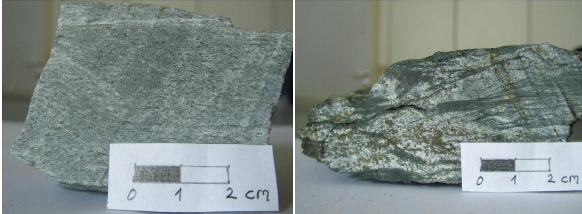
Abbildung 9: Grünschiefer, teilweise (stark) Pyrit-imprägniert; links: Probe P7, rechts: Probe P1
