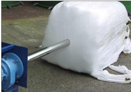
Abbildung 6: Probenahme aus quadratischem Silage-Ballen [7]
