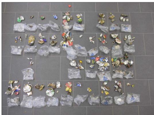
Abbildung 34: Aussortierte Aluminium-Teile der 40 Bohrproben
