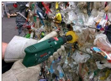
Abbildung 21: Handbohrmaschine und Lochsage (Innen-Ø 70 mm) in Anwendung
