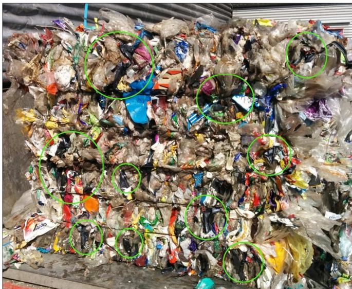
Abbildung 20: Dotierter Testballen mit verteiltem Markierungsmaterial (grüne Markierung)
