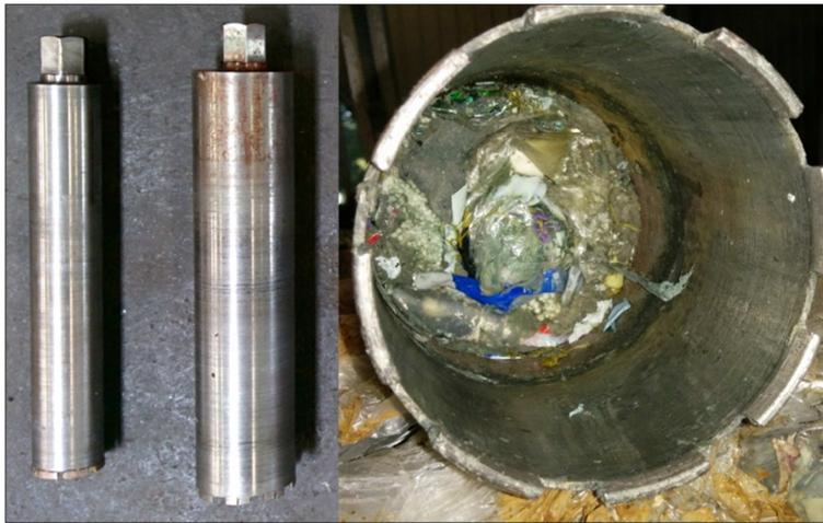
Abbildung 11: Diamantkronen-Hohlkernbohrer mit rechteckiger Zahnung
