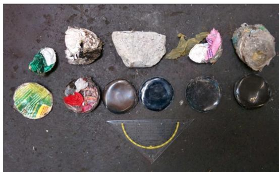
Abbildung 25: Bohrgut einer Bohrung in Pressrichtung
