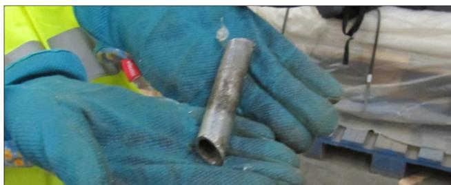
Abbildung 38: Metallischer Störstoff, mittels BBPM entnommen
