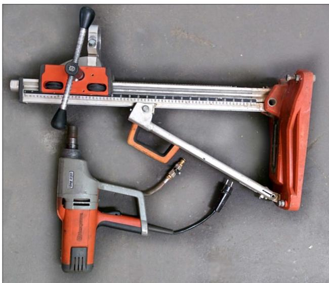
Abbildung 12: Bohrsystem für Hohlkernbohrungen (Bohrmotor und Gestell)
