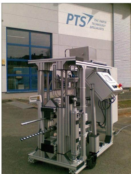
Abbildung 5: Mess-System für Papierballen der Papiertechnischen Stiftung (PTS) [14]
