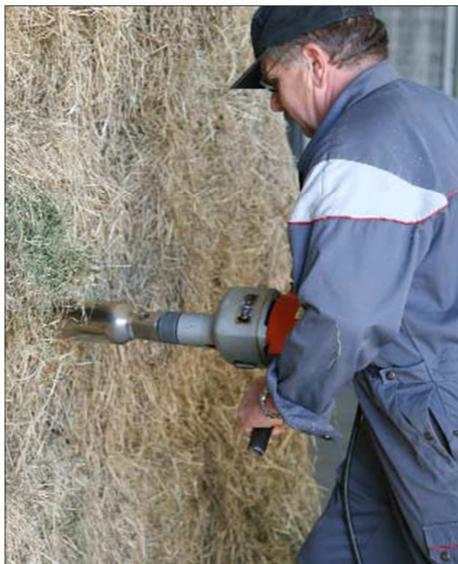
Abbildung 7: Probenahme mittels Handbetrieb [7]
