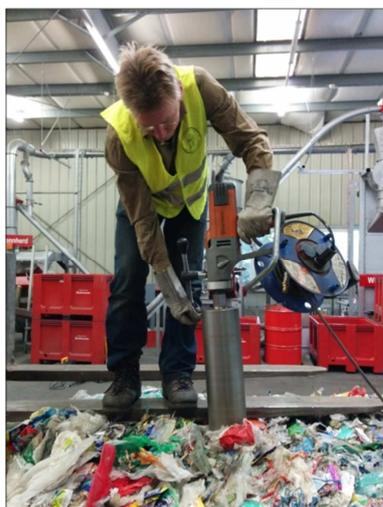
Abbildung 22: Hohlkernbohrsystem in Anwendung
