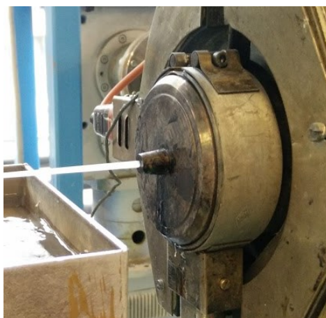
Abbildung 10: Hinzugefügtes Heizband auf der Düse.
