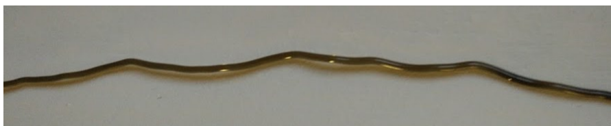
Abbildung 59: Durch die Abkühlung wellig werdendes Filament aus PPSU Ultrason P 3010.
