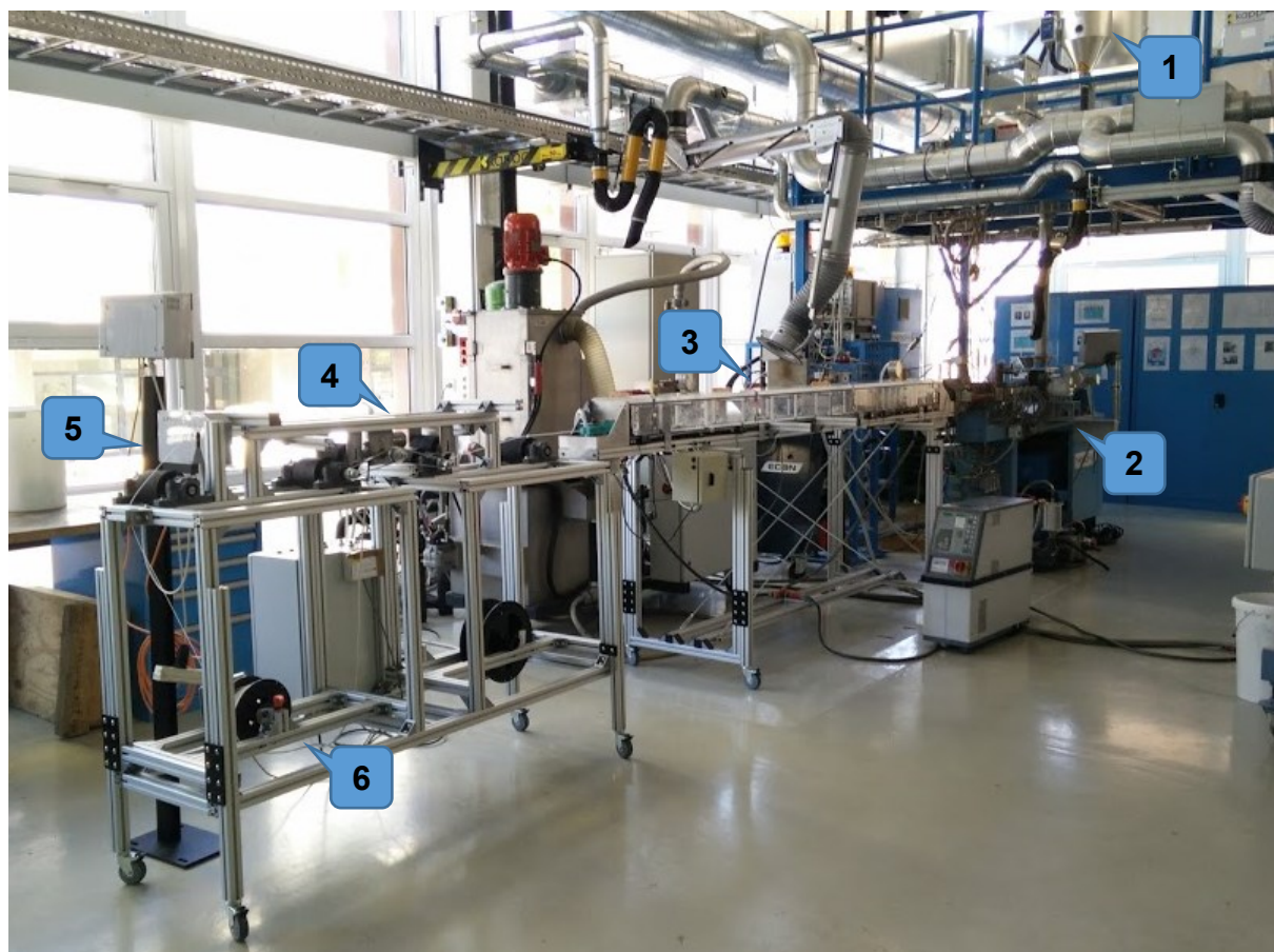
Abbildung 7: Aufbau der Anlage zur Filamentproduktion.
