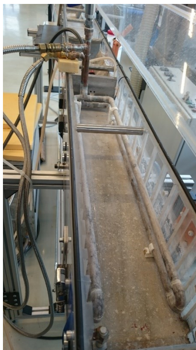
Abbildung 12: Neues Rohrsystem zur Temperierung des Wasserbades.
