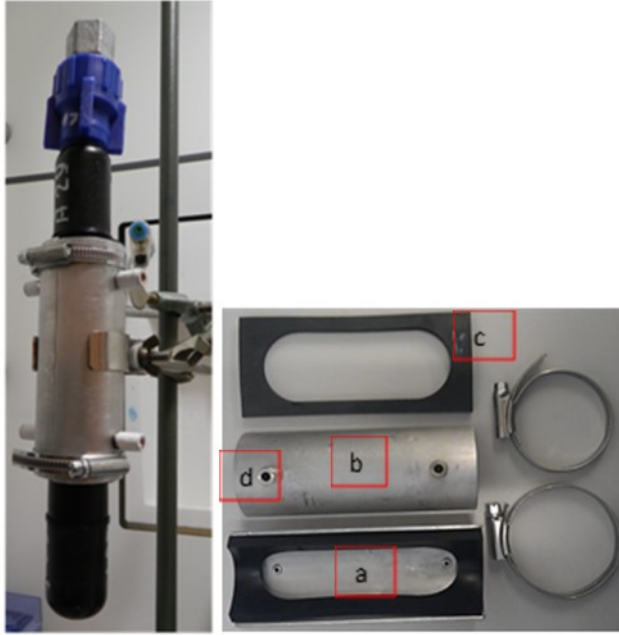
Abbildung 24: Aufbau "Schellenmessungen" zur Permeationsuntersuchung an Rohrprüfkörpern: Gasraum (a), Halbschale (b), Vitondichtung (c), Verschraubung (d)
