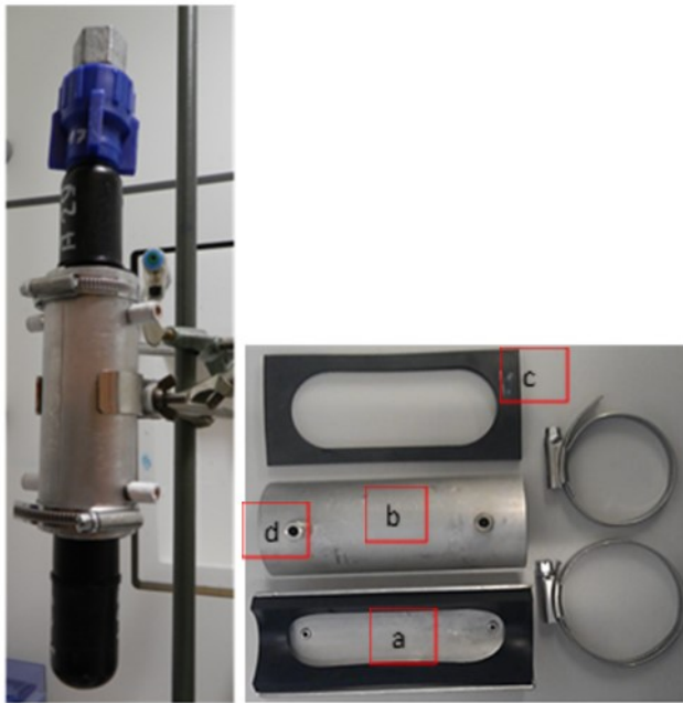
Abbildung 11: Aufbau "Schellenmessungen" zur Permeationsuntersuchung an Rohrprüfkörpern: Gasraum (a), Halbschale (b), Vitondichtung (c), Verschraubung (d)
