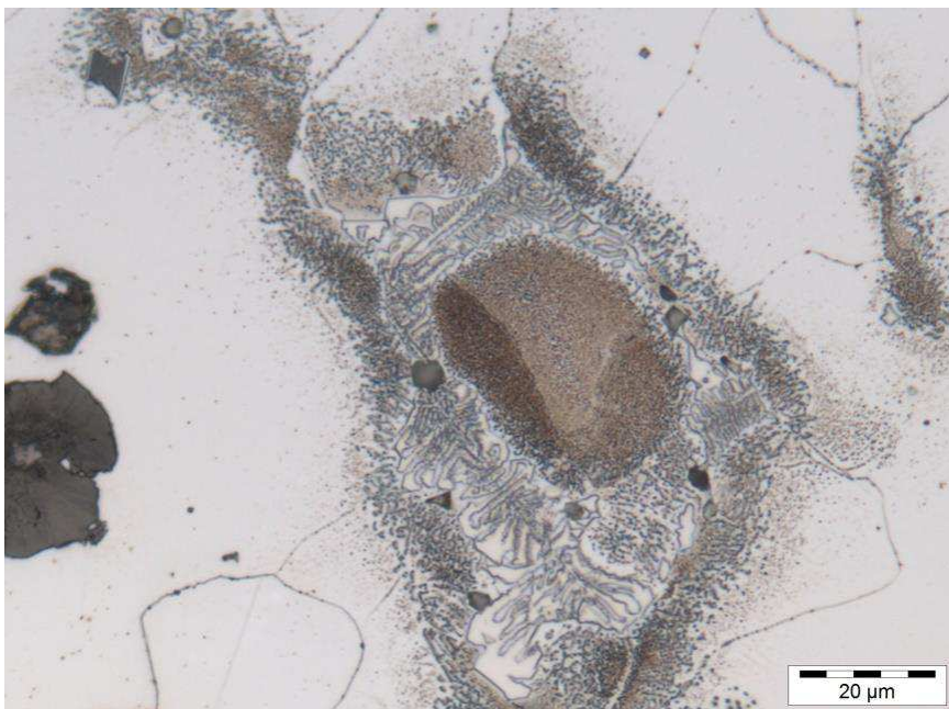
Abbildung 4.20: Genauere Betrachtung des Perlits, Karbidbildung
