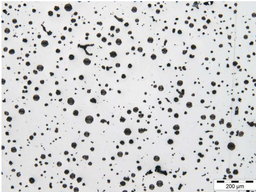
Abbildung 4.4: Ungeätzte Schliifffläche, gute Kugelausbildung
