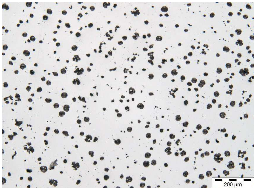
Abbildung 4.7: Ungeätzte Schliifffläche, Entartung des Graphits
