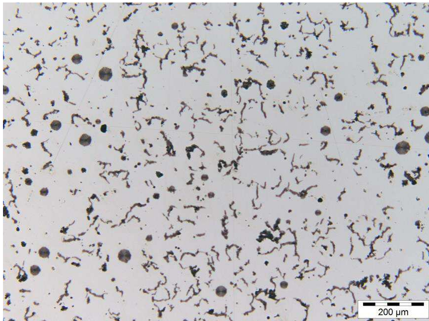
Abbildung 4.26: Ungeätzte Schlieffläche, mangelnde Kugelbildung aufgrund von Al-Anteilen
