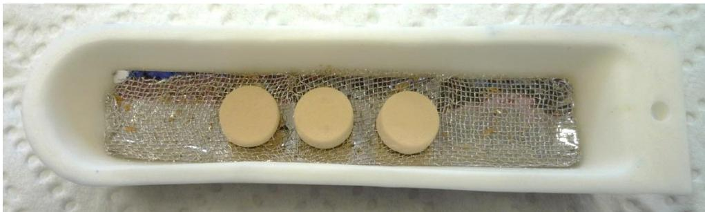
Abbildung 8: Grünlinge vor dem Sintern in Alumina-Schiffchen auf Platinblech mit Platingitter
