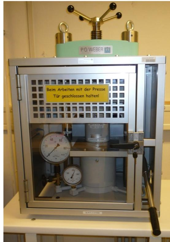
Abbildung 6: Isostatische Presse (P/O/Weber PW 30S, Presswerkzeug KIP-PKØ32mm) während des Pressvorganges
