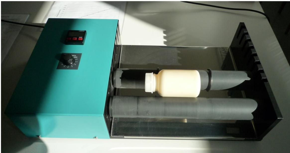
Abbildung 2: Rollbankmühle mit gefüllter Kunststoffflasche während des Mahlvorgangs
