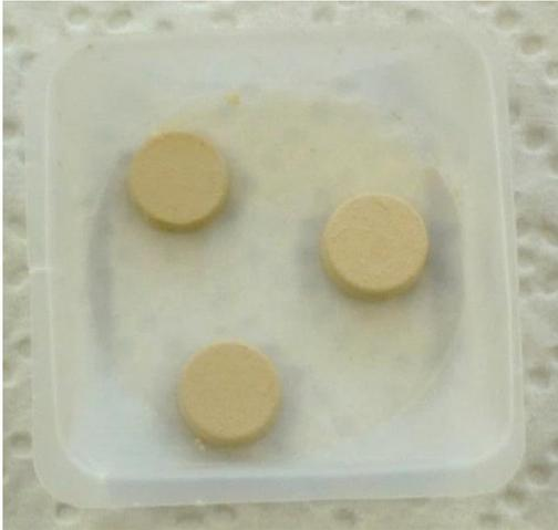
Abbildung 5: Gepresste Grünlinge einer Pulverzusammensetzung
