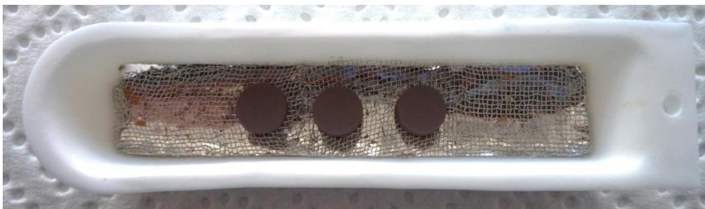
Abbildung 9: Probenkörper nach dem Sintern in Alumina-Schiffchen auf Platinblech mit Platingitter
